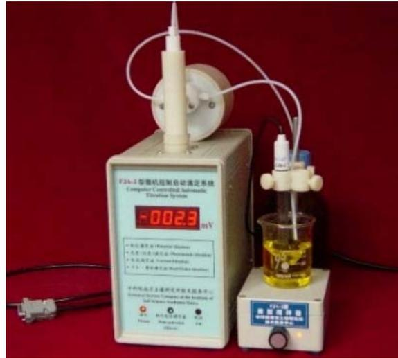
滴定系统配上相应的传感器,在8个应用软件的支持下,可实现多种微机控制自动滴定功能,包括电位自动滴定(微分滴定、平滑曲线滴定、永停终点滴和预设终点滴定)、光度自动滴定、电流自动滴定和卡尔-费休测水自动滴定、pH 自动滴定等。另外还有离子电极法(含 pH 测定)软件 7 个和光度法仪器联用软件 4 个。
