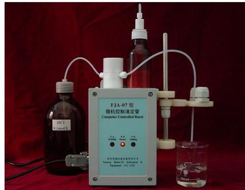
软件组成。初给状态是旋转阀在滴定位置，在操作界面中点击“发送”，滴定管开始滴定，一管发送完后，自动补液。当定值加液预置数值时，停止滴定。
